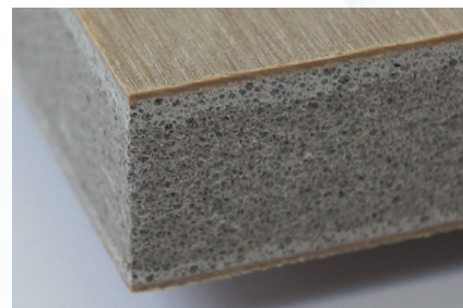
Tägliche Routine ist der Mix aus feuerhemmender Mittellage mit hochwertiger Deckschicht: Abrasives Blähglas mit einem spröden Furnier in Kombination. Das LEUCO DIAREX Formatkreissägeblatt schneidet die Mittellage als auch die Deckschichten sauber und mit langen Standwegen.
