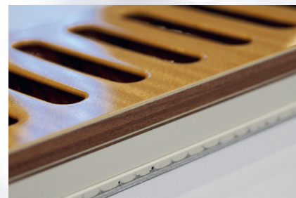
Verschiedene Hölzer sowie Furnier kombiniert mit Nonwood-Material und vor dem Lackieren mit dekorativen Lüftungsschlitzen gefräst, nach dem Lackieren nochmals an der Tischkreissäge formatiert. F/LIST setzt LEUCO-Werkzeuge ein.
