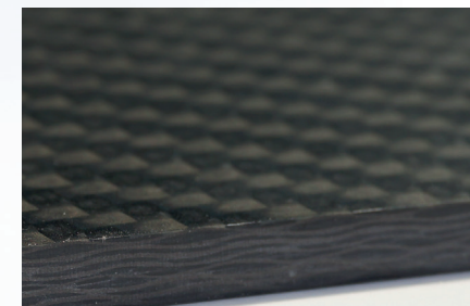
Kohlefaserwerkstoffe werden bei F/LIST seit vielen Jahren eingesetzt. Glatte Kanten erzielt F/LIST mit dem LEUCO p-System mit 70° Achswinkel.
