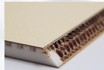
HPL-Deckschichten, Mittellage mit Wabenkern, Zwei-Komponenten-Kantenfüllung nach dem Aushärten auf Gehrung: F/LIST nutzt auch hierfür das Sägeblatt LEUCO DIAREX.
