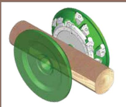
**Der Profilspaner kommt im Vor- und Nachschnitt zum Einsatz. Er erzeugt zwei planparallele Flächen an Rundholz oder Model.**
