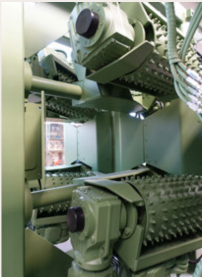
Ein doppeltes Stachelwalzenpaar für hochgenaue vollautomatische Eindrehung der Rundhölzer.
