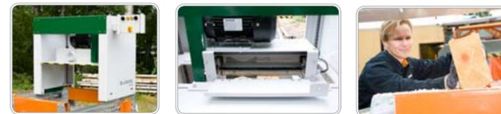
Mit dem zum Patent angemeldeten Balkenhobel bzw. Fräse bekommen Holzbau und Blockhausbau ganz andere Dimensionen. Die Balken können gefräst und gehobelt werden - genauer als je zuvor.
