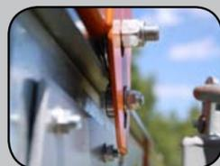
Verstellbare Klemmführung für den Sägekopf für einen stabileren und vibrationsfreien Lauf. **INKLUSIVE**
