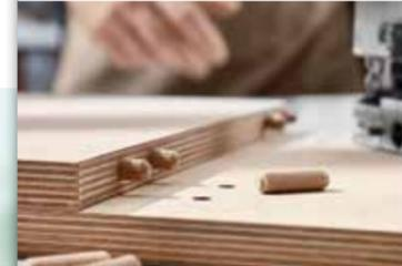
Bohrungen im 32-mm-Raster gehören zum Profi-Alltag. Wird ein anderes Dübel-System verwendet, ist dazu immer ein zusätzliches Gerät nötig. Mit dem DuoDübler DDF 40 lassen sich auch 32-mm-Lochreihen und -Beschlagbohrungen setzen – und dadurch komplette Möbel montieren.
