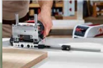
Das patentierte Anschlagssystem mit gefederten Anschlagstiften in der Grundplatte wurde einfach für den neuen Seitenanschlag SA 320 adaptiert. So lassen sich wiederholbar und ohne Anriss Lochpaare mit größerem Abstand zur Bezugskante extrem einfach setzen.
