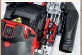
Mit den Tiefenanschlägen „1“ und „2“ können zwei Bohrtiefen eingestellt werden. Über den Drehknopf werden sie vorgewählt. Zusätzlich bietet der Drehknopf eine Einstellung für den Werkzeugwechsel, der automatisch den Einschalter blockiert.
