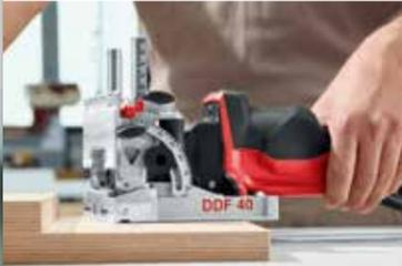
Der DDF 40 verfügt über eine flache Bauform mit ebener Grundplatte. Dadurch verbindet er das einfache Handling einer Flachdübelfräse mit allen Vorteilen einer Dübel-Verbindung.
