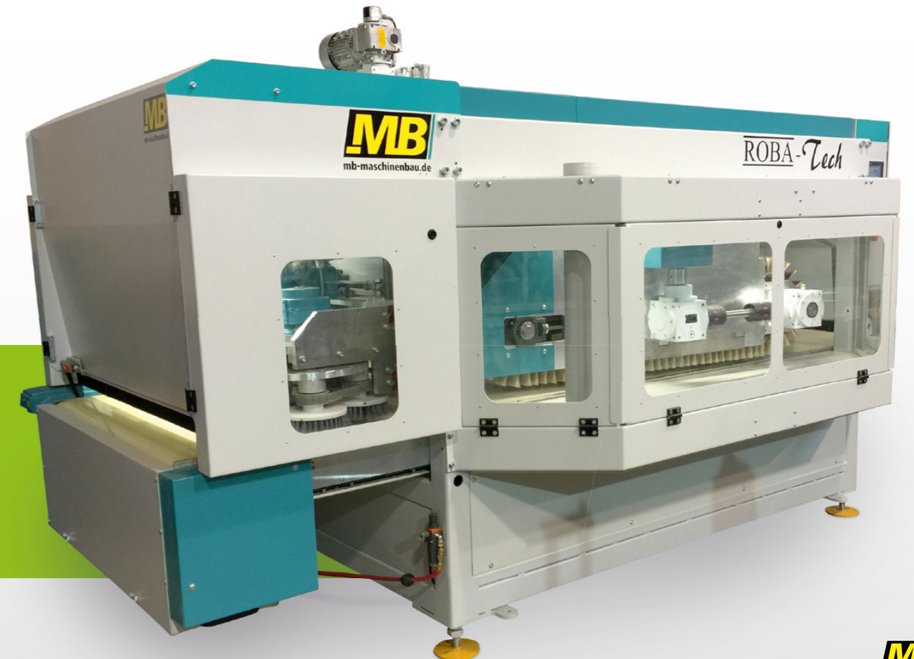
ROBA Tech Vertikal zum Schleifen von Türen, die in einem Fördersystem hängen
