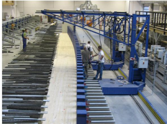
Automatisch verstellbares Pressbett mit verfahrbarem Auslegerwagen und hydraulischer Anzugseinheit
