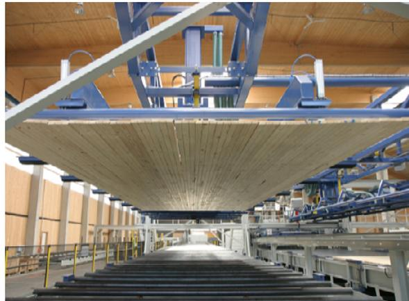
Zuführung der Längslagen mittels Vakuumsauger
