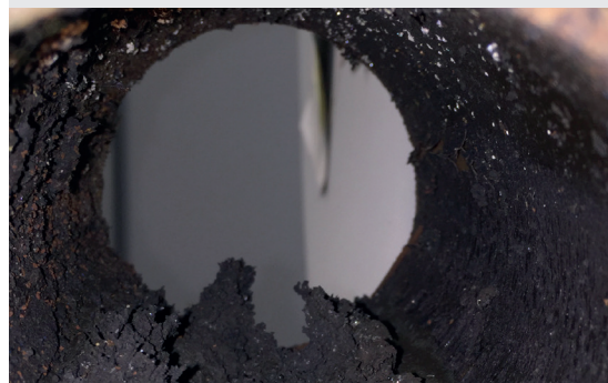
Ablagerungen in einem Rohr
