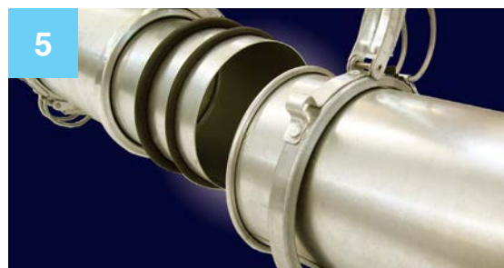
Schieben Sie nacheinander den O-Ring, den Öl-Nebel O-Ring (er ist schmaler) und das Schieberohr über das gekürzte Rohrende.
