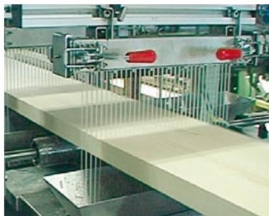
Getrennter Auftrag von Klebstoff und Härter auf Brettschichtholzlamellen
