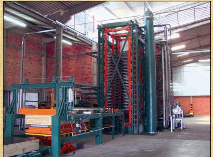
**PRENSA FENÓLICA COM CARREGADOR / DESCARREGADOR AUTOMÁTICO
