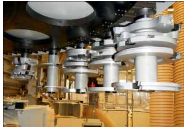
Hybridwerkzeuge im Werkzeugmagazin
