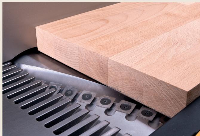
vollkommen neue Bearbeitungsmöglichkeiten. Ist so doch selbst das Hobeln von MDF folgenlos möglich. Kommt es, etwa durch Metalleinschlüsse oder Steinchen, dennoch zu einer Beschädigung der Schneide, muss nicht der komplette Messersatz der Messerwelle ausgewechselt werden. Es werden einfach zwei oder drei kleine günstige Hartmetallmesser auf der Welle gedreht - fertig. Jedes XS-Messer bietet vier Nutzen und trägt auch dadurch spürbar zur Kostensenkung bei.
