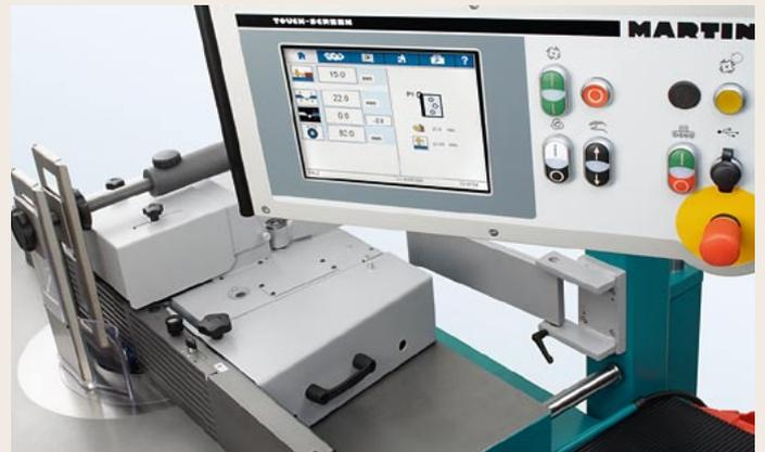
Elektromotorische Positionierung der Einlaufbacke
