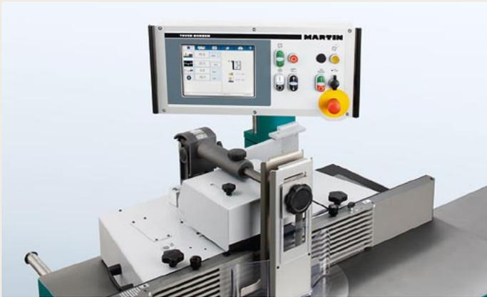
Elektronische Positionierung des Fräsanschlags
