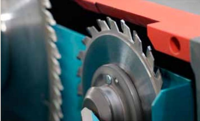
Elektrisch verstellbares 3-Achs-Vorritzaggregat T7523
