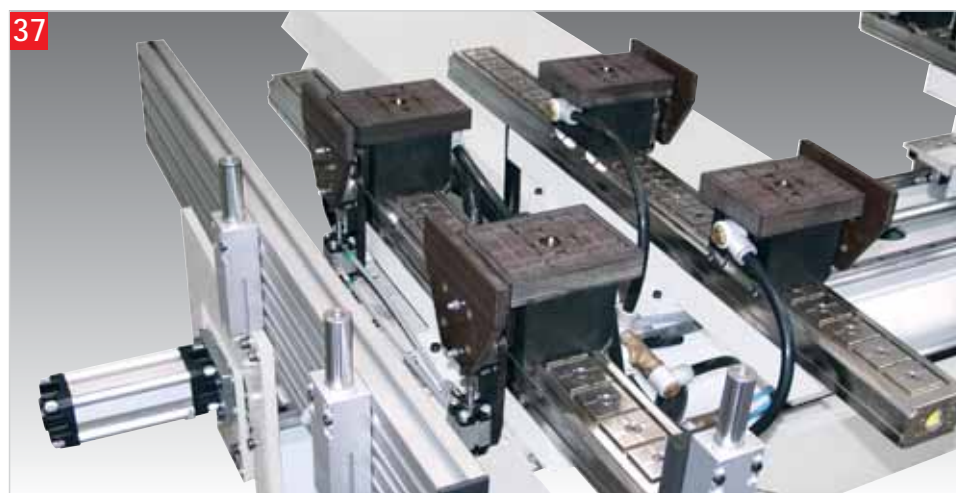
37 TGV / VM TGV + ventose a fissaggio meccanico TGV + vacuum cups with mechanic fixing system TGV + coupe aspirante à fixage mécanique TGV + ventosas de fijación mecánico TGV + Vakuumsauger mit mechanischer Halterung
