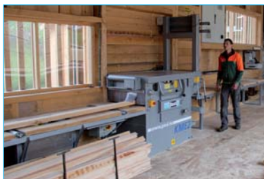
KME2-750 mit manueller Beschickung im Sägewerk
