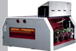
Modular aufgebaute, flexible Mehrblattkreissäge K34M
