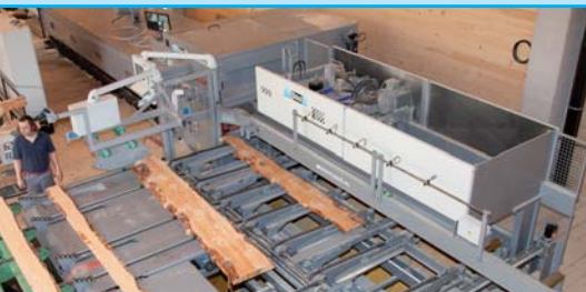
Vollautomatische Beschickung AB920-XL in Kombination mit einer SGL-1518 zur Bearbeitung von großen und schweren Werkstücken
