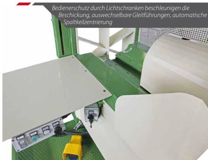
Bedienerschutz durch Lichtschranken beschleunigen die Beschickung, austauschbare Gleitführungen, automatische Spaltkeilzentrierung
