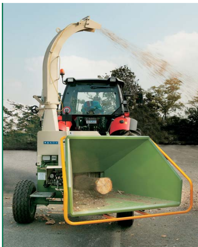
Modell H 880/250 hackt Stammdurchmesser bis 250 mm.
