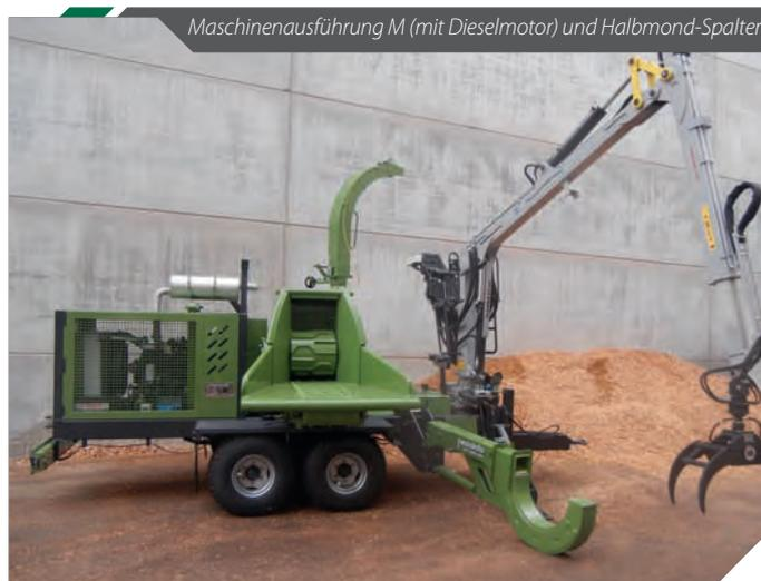
Maschinenausführung M (mit Dieselmotor) und Halbmond-Spalter
