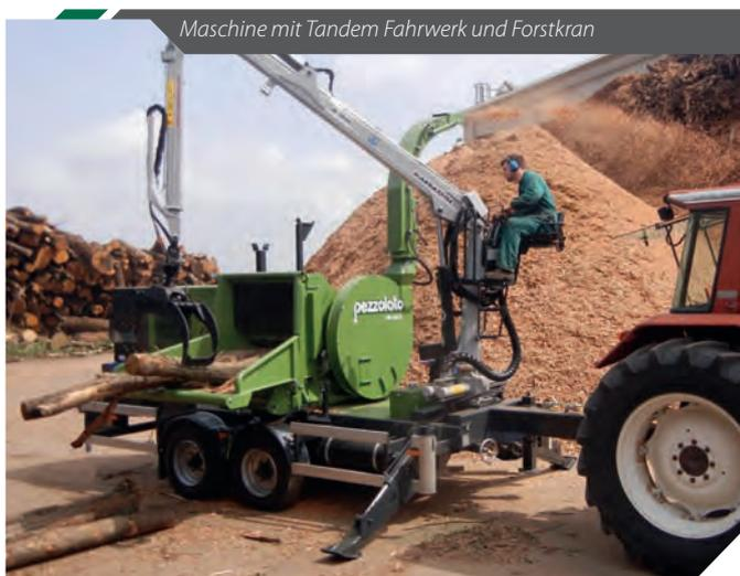
Maschine mit Tandem Fahrwerk und Forstkran
