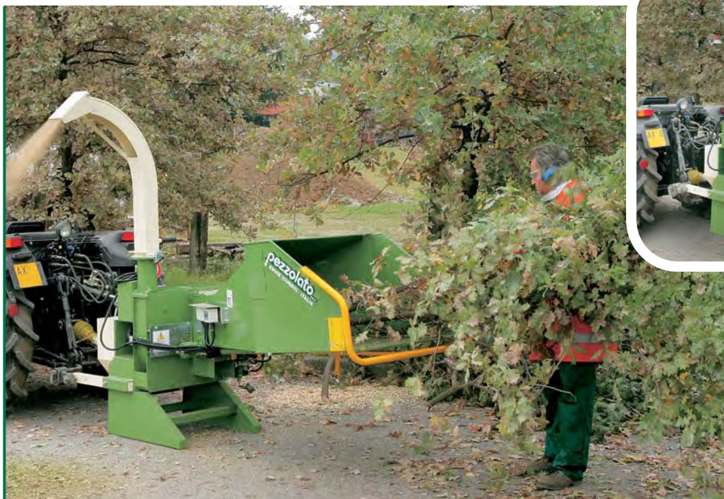
Modell PZ 110 G bei der Arbeit. Die Maschine arbeitet mit Gelenkwellenantrieb und ist in der 3-Punkt des Schleppers angebaut. Die Detailabbildung zeigt die Maschine in Transportstellung mit eingeklapptem Einzugsstrichter.
