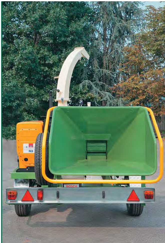
Scheibenradhacker PZ 210 M. Diese Maschine wird von einem HATZ-SILENT-Motor mit 52 PS angetrieben und ist auf ein Fahrwerk 80 km/h montiert. Der seitliche Aufbau des Motors macht die Maschine sehr kompakt.
