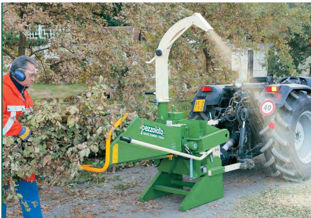
Modell PZ 100 G bei der Arbeit. Die Maschine arbeitet mit Gelenkwellenantrieb und ist in der 3-Punkt des Schleppers angebaut.
