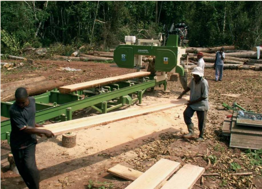
Dort müssen die Maschinen besonders **robust und zuverlässig** gebaut sein. Sie werden im Freien betrieben (auch in der Regenzeit) und arbeiten mitten im Wald (die nächste Service-Werkstatt ist Tage entfernt).
