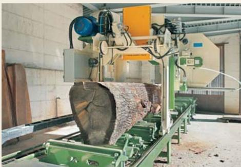
• Der verbreiterte Sägekopf der Maschine ermöglicht die Bearbeitung von **Stämmen bis 1,20 m Durchmesser**.
