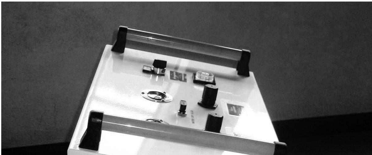
\_ Sistema per l'applicazione di colle viniliche con doppia funzione per settaggio erogazione colla\_ manuale e temporizzata\_ controllo da PLC
