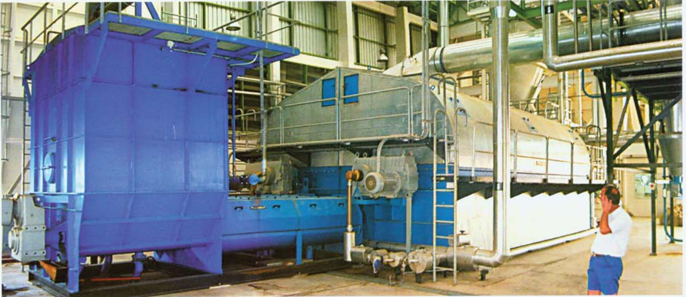
Röhrenbündeltrockner mit Entwässerungspressen Tubular Bundle Drier with dewatering press
