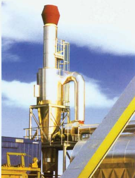
Schwadenabsaug- und Entstaubungsanlage Vapour Exhaust and Dust Removal Plant
