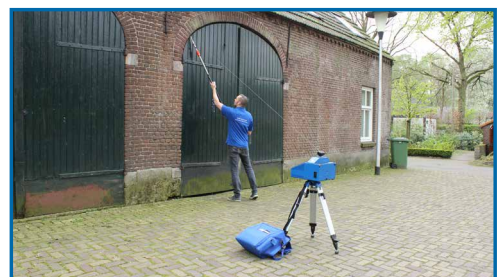
Proliner Verlängerungsstück zum Messen von Stellen die schwierig zu erreichen sein
