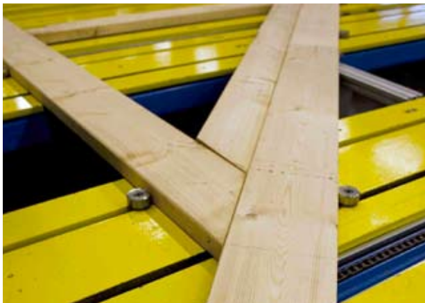
Die Anschläge für das Bauholz positionieren sich automatisch
