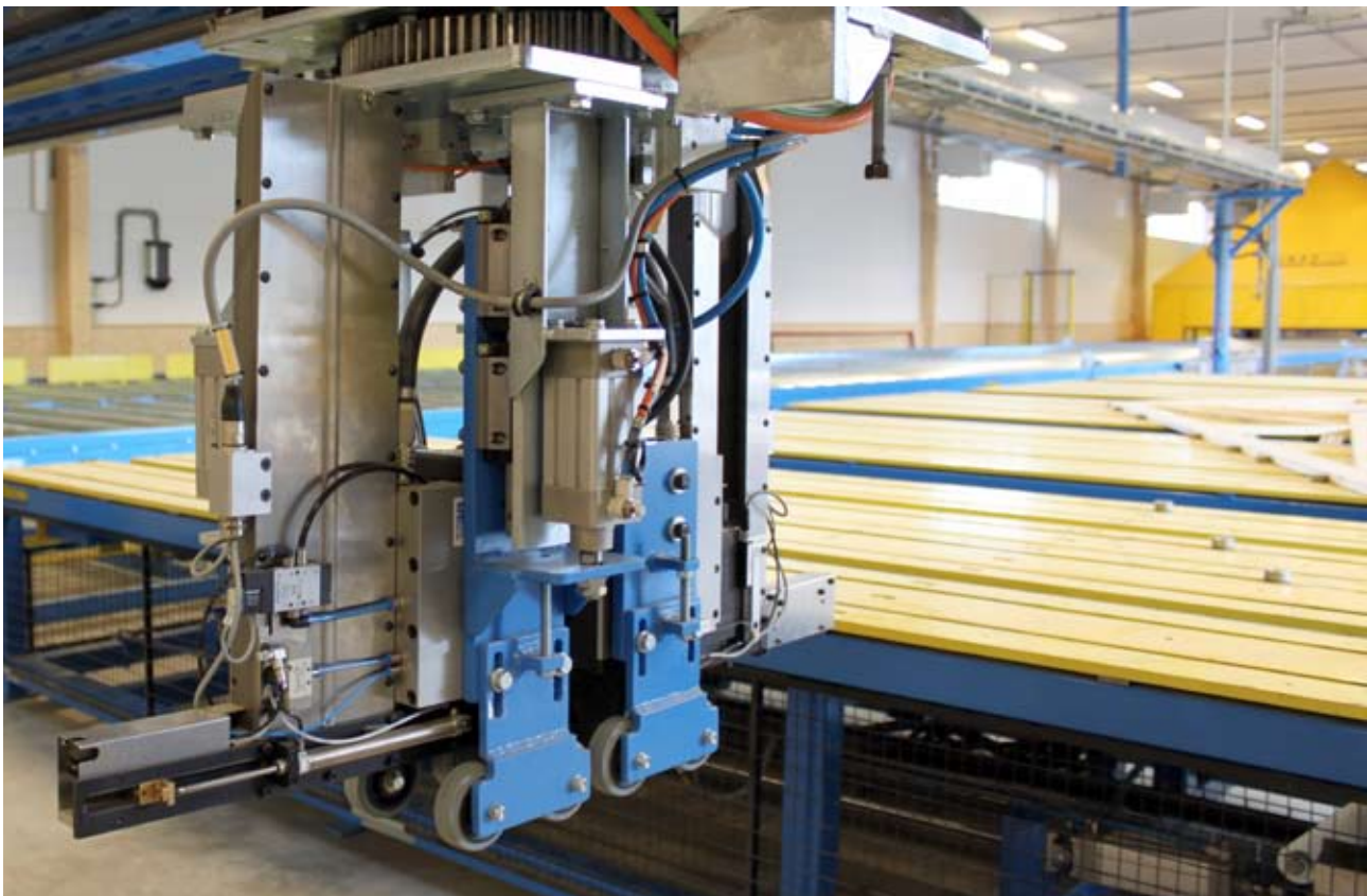
Puck-Tisch mit Heftportal zur Fixierung des Bauholzes
