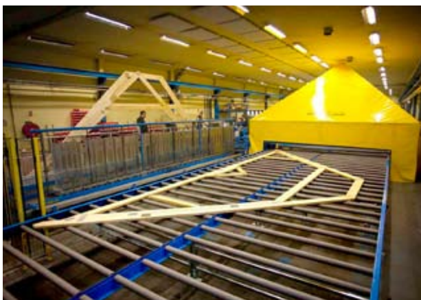
Der Pressvorgang basiert auf Photoerkennung und hochentwickelten Hydrauliksystemen
