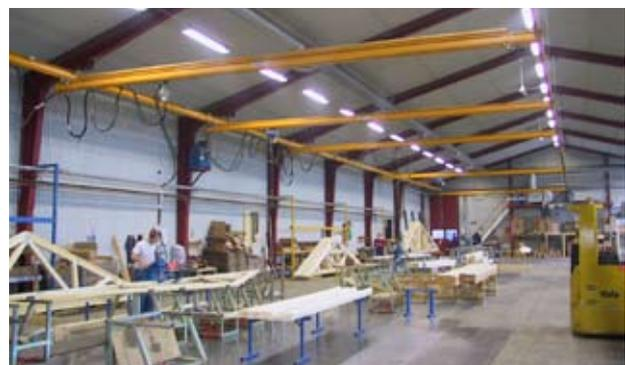
Presslinie mit leichter Überkopf-Krananlage
