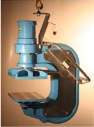
Eine Presse, die für die Herstellung von Dachstühlen verwendet wird, ist immer wieder durch die zu erbringende hohe Presskraft enormen und ständigen Belastungen ausgesetzt. Aus diesem Grunde sind Randeks hydraulische Pressen extrem robust gebaut während gleichzeitig die C-Form einfache Handhabung und hohe Flexibilität ermöglicht. Die maximale Presskraft liegt zwischen 23 und 50 Tonnen, je nach Modell. Die Pressen sind besonders für das Einpressen von Nagelplatten in Bauholz konstruiert.
