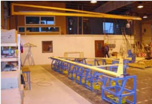
Der Ausleger ist 7 Meter lang und kann Lasten bis zu 320 kg aufnehmen. Er ist mit Kabel-Ketten ausgestattet, in denen die Kabel und die Hydraulikschläuche kontrolliert geführt sind. Die Arbeitshöhe der Presse wird durch einen Kettenzug eingestellt. Eine Gasdruckfeder kompensiert die Hubbewegung der Presse während des Pressvorganges. Der Kettenzug macht es einfach, die Presse über den Dachbinder zu heben, wenn von der Innenseite des Fachwerks gepresst werden muss.
