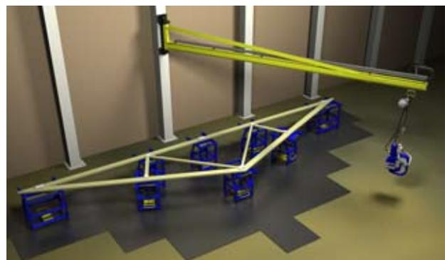
Auflegetische auf Stahlboden mit Magneten fixiert
