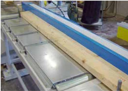
So wie Zufuhrbahn ist auch die Ausförderbahn mit Fixiereinrichtungen und Niederhaltern ausgerüstet. Dies um einen präzisen Sägeschnitt sicher zu stellen.
