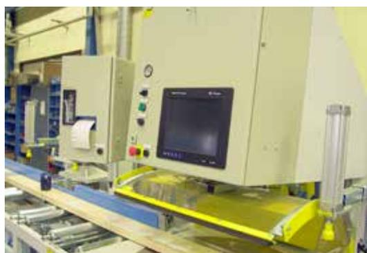
me, Bezeichnung der CAD-Datei und Holzdimensionen. Der Drucker ist für sichere und staubfreie Funktion in einem Kabinett untergebracht. Der Knopf für den Druckbefehl befindet sich auf dem Kabinett und ist genau vor dem Bediener.
