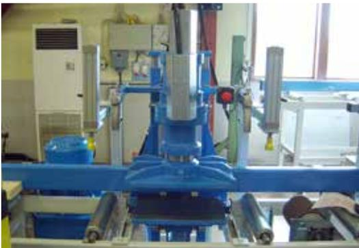
Die Presskraft beträgt 35 Tonnen. Die Bahn ist mit Niederhaltern und Fixiereinrichtung ausgerüstet, die das Holz vor dem Einpressen der Nagelplatten ausrichtet und festhält.
