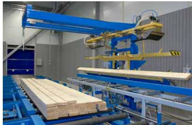
*Holz-Beschickung mit zusätzlicher Rollenbahn*
