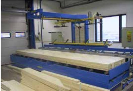
Dieser fördert es weiter auf die Zufuhrbahn. Der Bediener entscheidet ob das Holz vom „Elevator“ auf die Zufuhrbahn abgeschoben werden soll oder durch kippen gewendet werden soll. Diese Wahlmöglichkeit ist für den Hersteller von Dachbindern sehr wichtig wo man die Krümmung im Verhältnis zum Sägeschnitt haben möchte.
