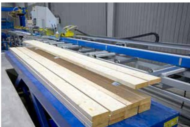
*Das bearbeitete Holz wird auf einem Hubtisch abgestapelt*
