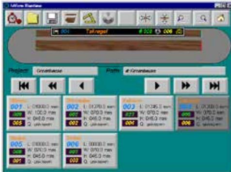
Sie können eigene Bearbeitungen erstellen oder einfach komplette Projekte aus dem CAD-Programm importieren. Das einzige was noch zu tun ist, ist das Sägeprogramm zu starten.
