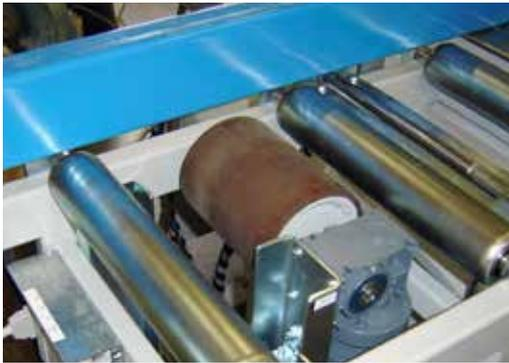
Die Fixiereinrichtung presst das Holz gegen den hinteren Längsanschlag und richtet es somit aus um einen präzisen Sägeschnitt sicher zu stellen. Die Fixiereinrichtung wird vor dem Sägevorgang automatisch aktiviert.
