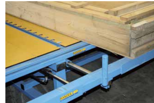
Ansicht der hydraulischen Breitereinstellung mit Verpressfunktion (BS2-HW3100HS)
