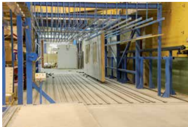
Ansicht eines vertikalen Lager-System. Es kann direkt aus dem BS20-System gespeist werden, wenn dieses mit der Option BS2-RVP ausgestattet ist.
