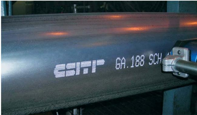
Beschriftung von Stahlrohren
