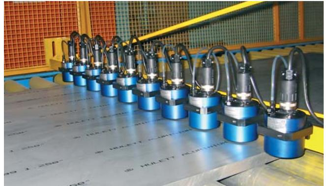
Kennzeichnung von Aluminiumplatten
