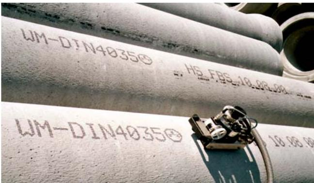
Mobile Beschriftung von Betonrohren
