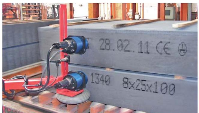
Codierung von Betonfertigteilen
