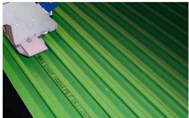
Kennzeichnung von Kunststoffprofilplatten
