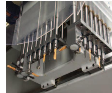
Zur Auswahl der Aggregate steht neben der Grundausführung mit einer Frässpindel, eine Werkzeugschnittstelle HSK-F63 sowie ein Mehrfachbohraggregat mit 15 oder 25 einzeln vorlegbaren Spindeln zur Verfügung. Beim Einsatz einer wassergekühlten Frässpindel wird die Leistungsaufnahme permanent überwacht und die Spindel ist somit vor Schäden geschützt.
