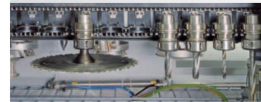
Die Aggregatebewegungen verlaufen innerhalb des gekapselten Portals, wobei die Werkzeuge alle Vorschubbewegungen ausführen. Die mitfahrenden, automatischen Werkzeugwechselsysteme mit bis zu 36 Werkzeugplätzen (Ketten-Werkzeugmagazin) und einem maximalen Flugkreis von 300 mm, gewährleisten den Einsatz größerer Werkzeuge und handelsüblicher Zusatzköpfe.
