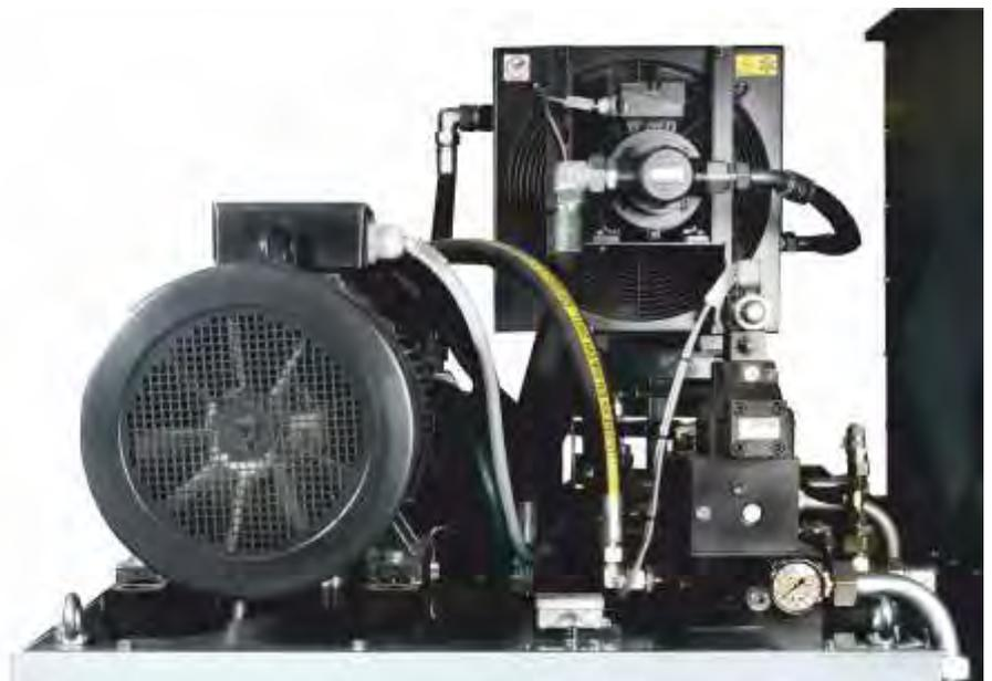
Hydraulikaggregat mit Axialkolbenpumpe und Kühlung für den Mehrschichtbetrieb
