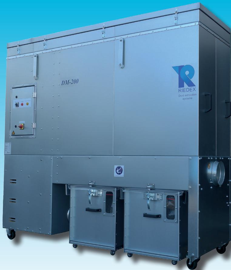
Unsere Entstauber im Unterdruckverfahren sind entwickelt worden für die Absaugung von Holzspänen, Holzstaub und artverwandte Stoffe aber auch für verschiedene Kunststoffe, trockene Aluminiumspäne und Papierstäube.
