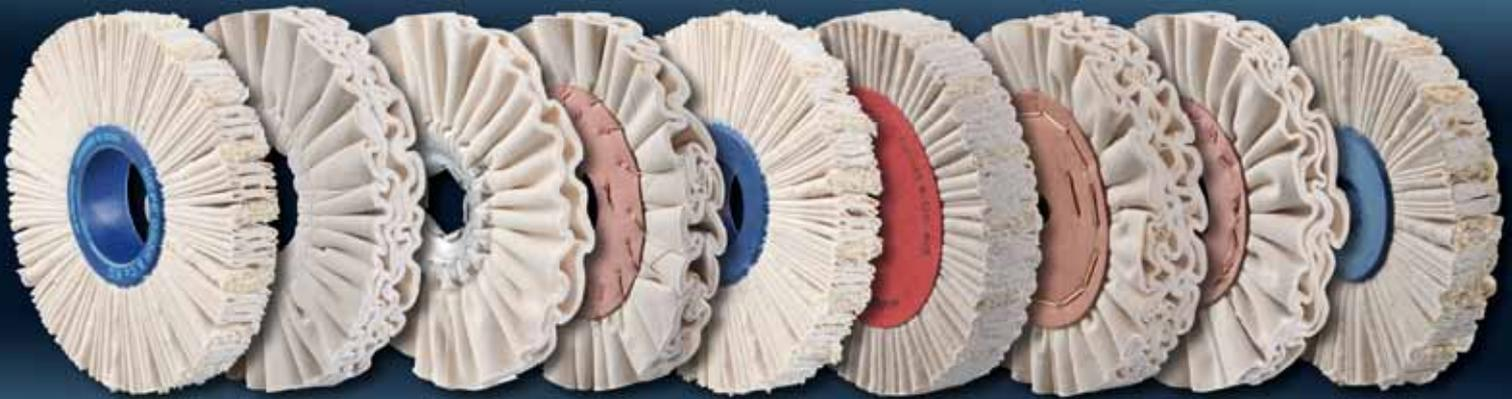
Die original **RIEPE®** Tuch-Schwabbelscheiben und Tuch-Sisal-Lamellenräder sind speziell für den Einsatz bei Dick- und Dünnkanten in der Praxis entwickelt worden. Für Kantenbänder (>1 mm) eignen sich besonders die **Tuch-Schwabbelscheiben**. In Kombination mit dem zuvor aufgesprühten **Reinigungsmittel LP163/93** wird der Kantenbandradius poliert und passt sich somit im Glanz der Oberfläche an.
