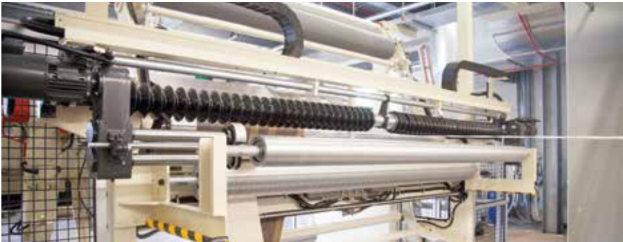
Wickeltechnik mit unterbrechungsfreiem Rollenwechsel
