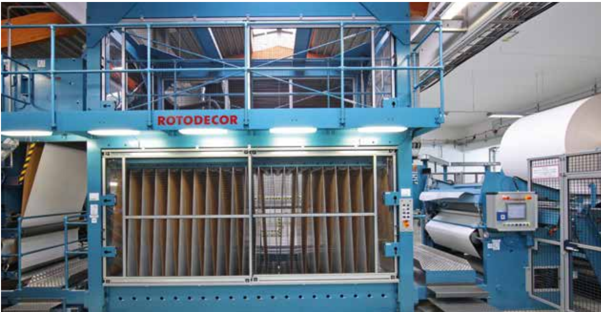
Bahnverbindungssystem ohne Überlappung der Materialbahn (Stoß an Stoß) mit Materialspeicher
