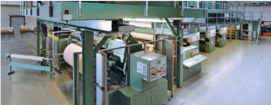
3-Farben-Tiefdruckmaschine für den Dekordruck
