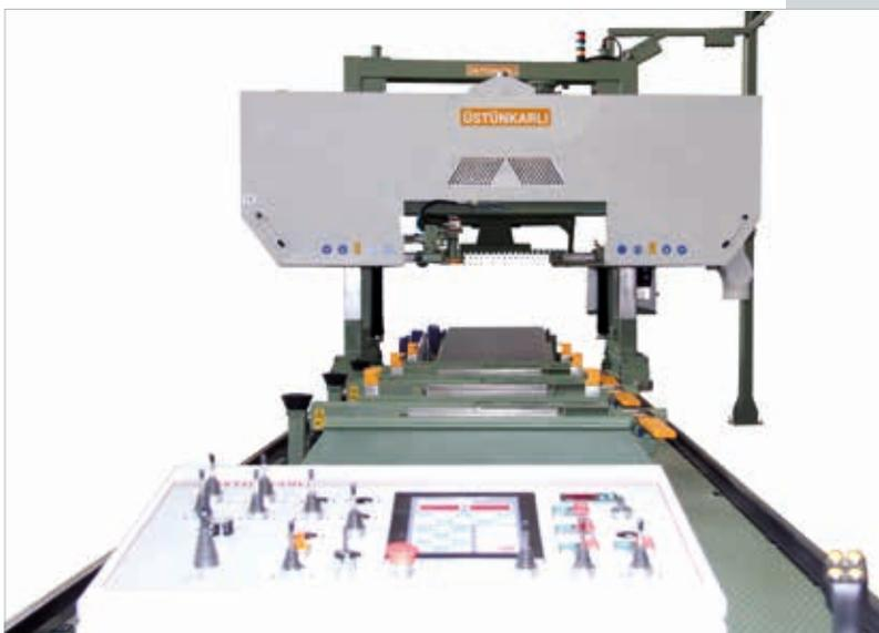
Horizontale Blockbandsäge mit Bedienpult;
