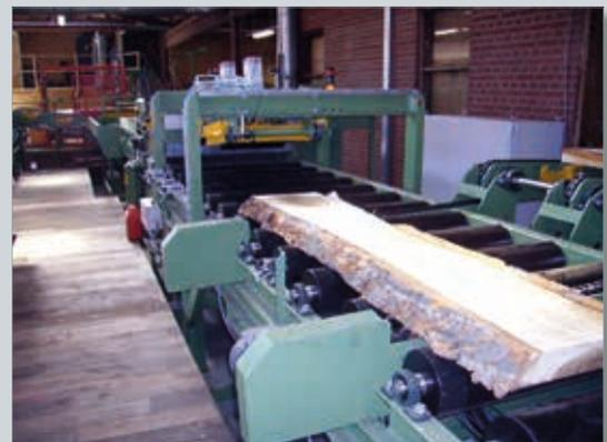
Ausrichtstation und Einzugsaggregat
