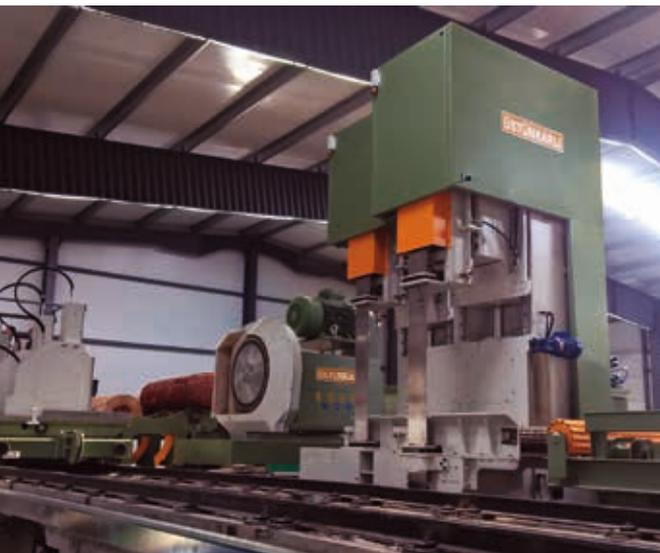
Tandem-Blockbandsäge mit Spanner
