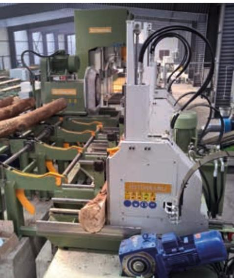
Standard Blockbandsäge mit oder ohne Spanner
