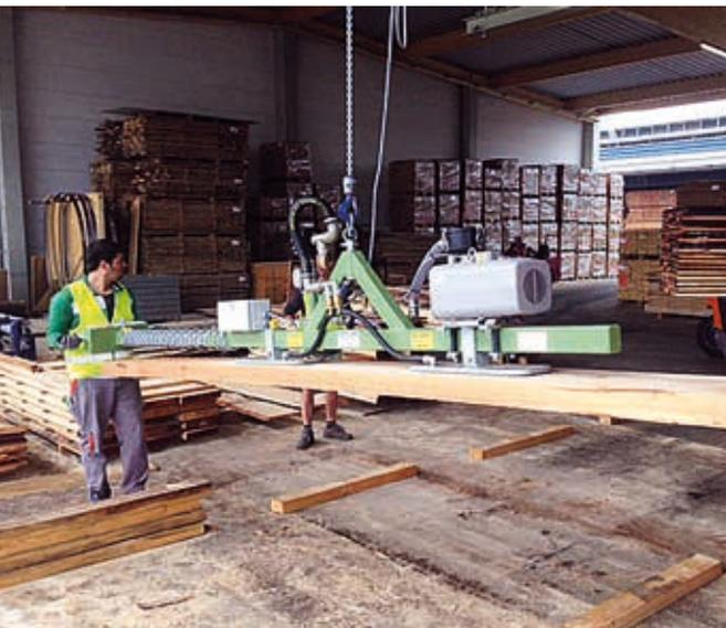
Manueller Vakuumheber mit V-Kettenzug
