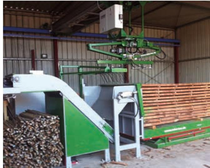
Umstapelanlage mit Lattenabstreifer und Lattensammler
