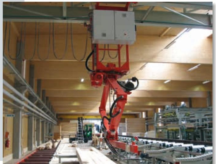
Scheren-Roboter für KVH-Holz
