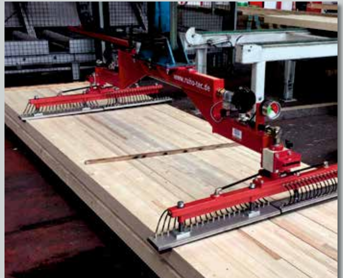
Schwenkbare Saugplatteneinheiten Swivelling vacuum plate units
