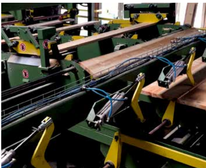
Durchlauf-Kappsäge Crosscutting saw
