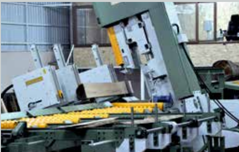
Blockbandsäge um 17° geneigt Log bandsaw 17° inclined
