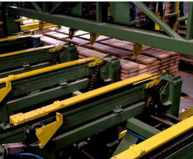
Stapelanlage mit automatischem Leistenleger Stacking unit with automatic placement of stacking laths
