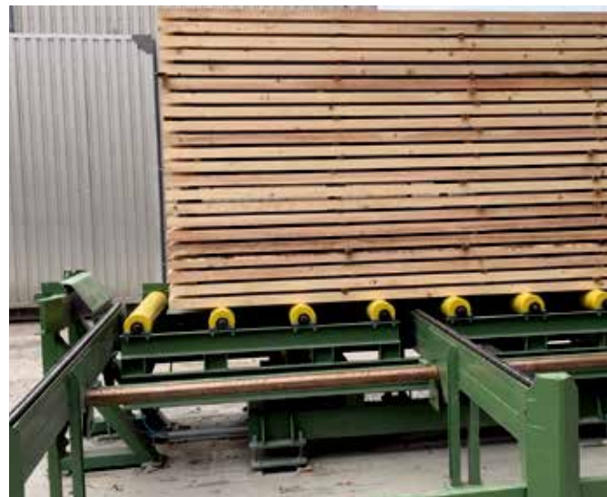
Fördertechnik für Schnittholzstapel Mechanisation for packages
