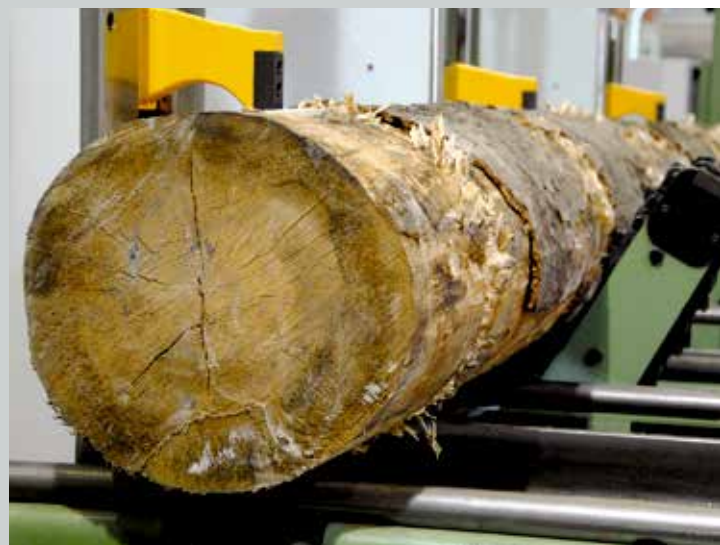
Spannwagen mit hydraulischen Stammwendern Clamping carriage with hydraulic log turner
