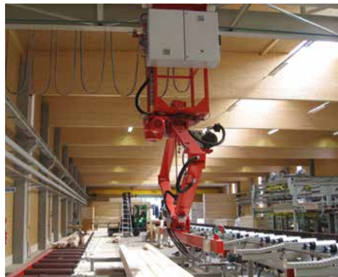
Scheren-Roboter für KVH-Holz Shears robot for construction timber
