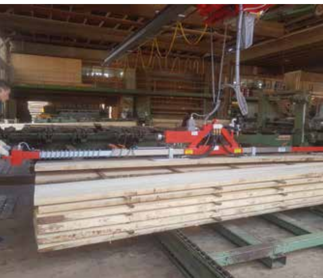
Manueller Vakuumheber mit V-Kettenzug Manual vacuum jack with v-chainlift
