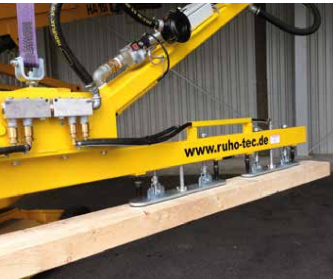
Spezielle Vakuumgreifsysteme entsprechend dem Einsatzfall Specific vacuum gripping systems for each application
