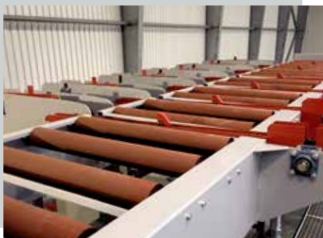
Rollenbahn mit Querabzug Roller conveyor with transverse removal
