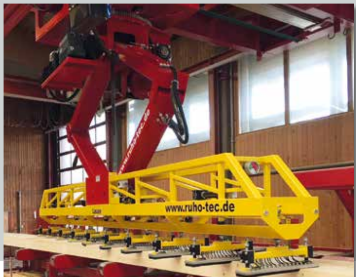
Stapelroboter mit schwenkbaren Saugplatten Stacking robot with swivelling vacuum plates
