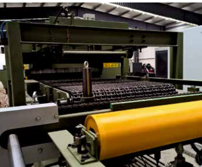
Ausrichtstation mit Einzugsaggregat Alignment station with infeed unit
