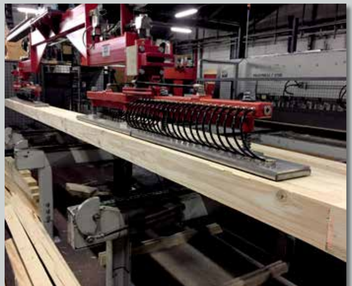
Schwenkbare Saugplatteneinheiten Swivelling vacuum plate units
