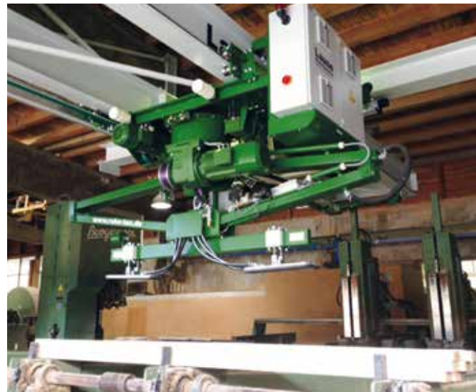
Scheren-Roboter für Nadelholz Shears robot for softwood
