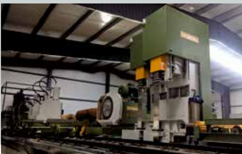
Tandem-Blockbandsäge mit Spaner Tandem log bandsaw with canter
