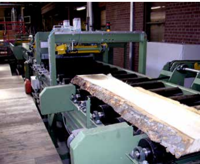
Ausrichtstation mit Einzugsaggregat Alignment station with infeed unit
