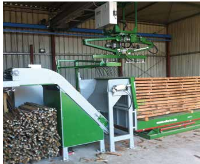
Umstapelanlage mit Lattenabstreifer und Lattensammler Unstacking unit with stick stripper and stick collector
