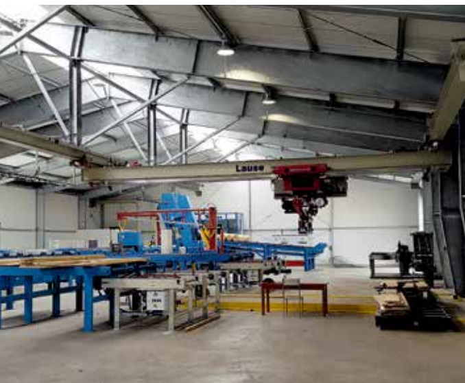
Vakuumstapelroboter nach Bandsägenlinie Vacuum stacking robot after bandsaw line
