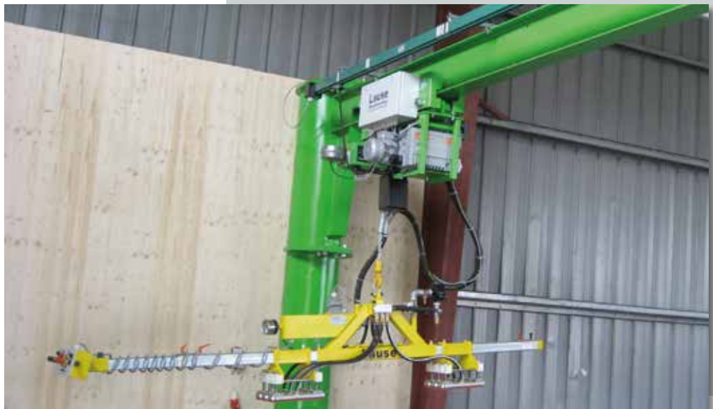
Manueller Vakuumheber mit Kettenzug an einer Drehsäule Manual vacuum jack with chainlift at column
