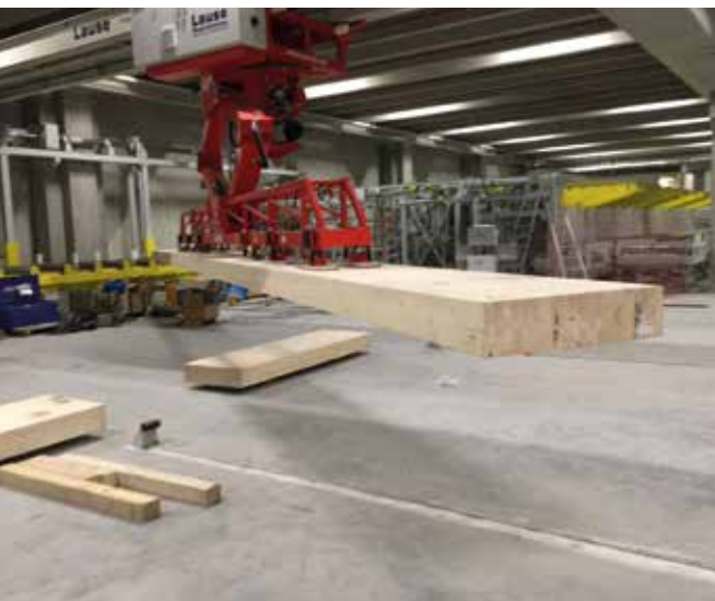
Vakuumgreifsysteme für hohe Lasten. z.B. hier 2.000 kg Vacuum gripping systems for high capacity. e.g. here 2.000 kg
