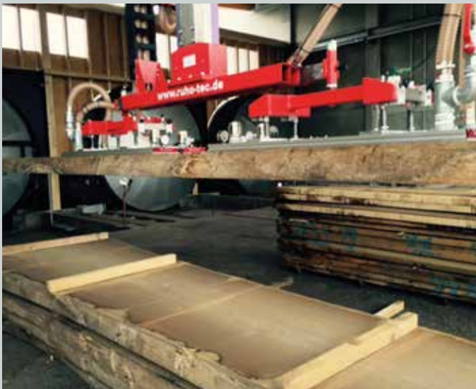
Stapelroboter mit Hubsäule Stacking robot with lifting column
