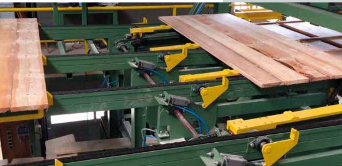
Stapelanlage mit Lagenpuffer Stacking unit with buffer for layers
