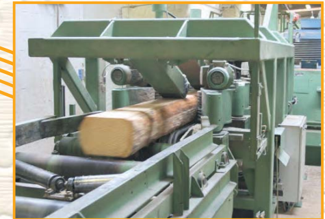
Nachschnitteinzugstransporteur mit automatischer Stammausrichtung Edging infeed conveyor with automatic log alignment
