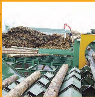
Stufenvereinzeln- förderer und Kurvenwender Step-by-step sorting and curve turner
