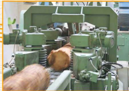
Einzugstransporteur mit automatischer Stammeindrehung Infeed conveyor with automatic log turner
