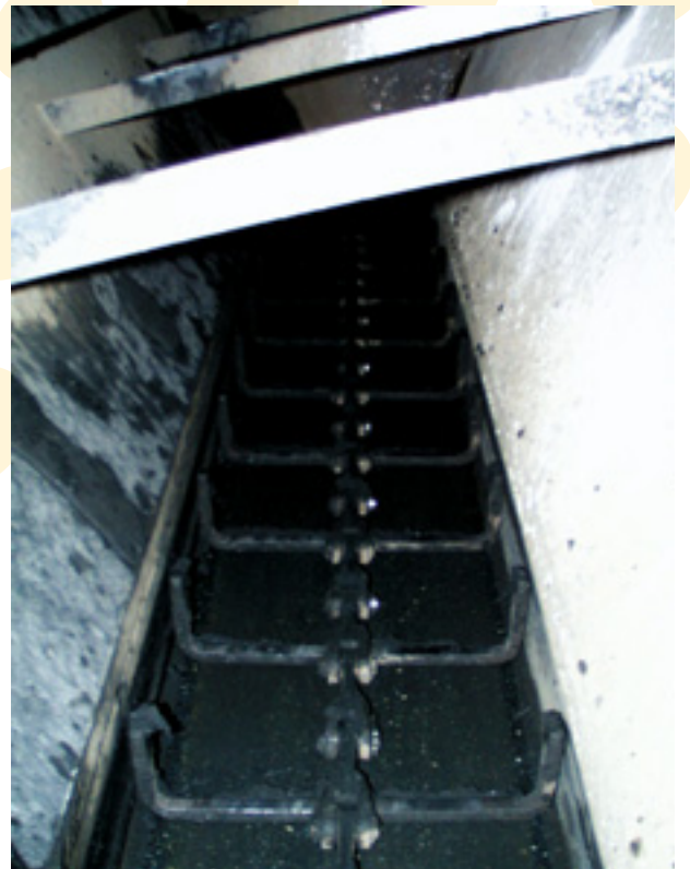
Frischwasserwerk Leuna-Daspig Förderung und Lagerung von mechanisch entwässertem Flußschlamm.
