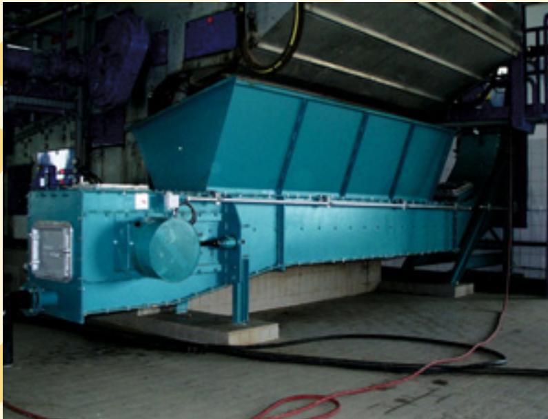
Frischwasserwerk Leuna-Daspig Förderung und Lagerung von mechanisch entwässertem Flußschlamm.
