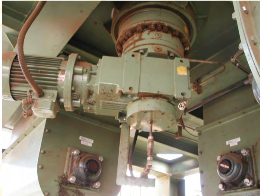
Hydraulikrotor mit Planetenradgetriebe und sternförmiger Schneckenanordnung
