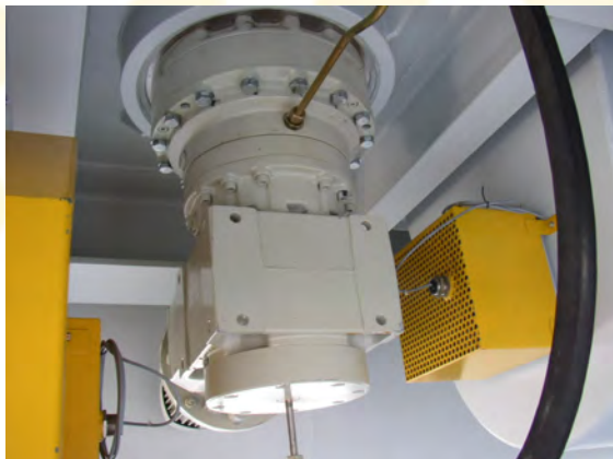
Planetenradgetriebemotor mit Öldurchführung. Bis 200.000 Nm Drehmoment können installiert werden.
