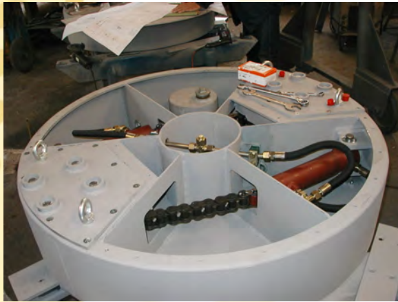
Rotorgehäuse während der Montage des Hydrauliksystems der Rotorarme
