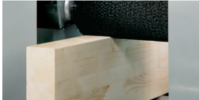
Das Werkstück verlässt den IMPREGMAT® in einer konstanten Oberflächengüte, wie sie mit Handarbeit nicht zu erreichen ist.
