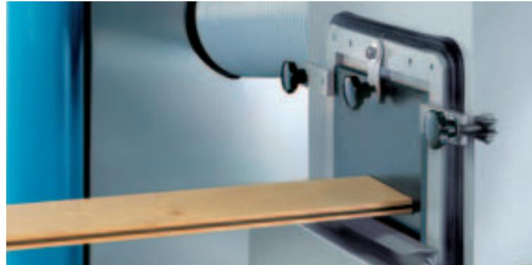
Die VACUMAT®-Beschichtungskammer ermöglicht Rundumbeschichtung in einem Arbeitsgang. Auch hinterschnittene Profilstücke werden mit hoher Anwendungssicherheit beschichtet.
