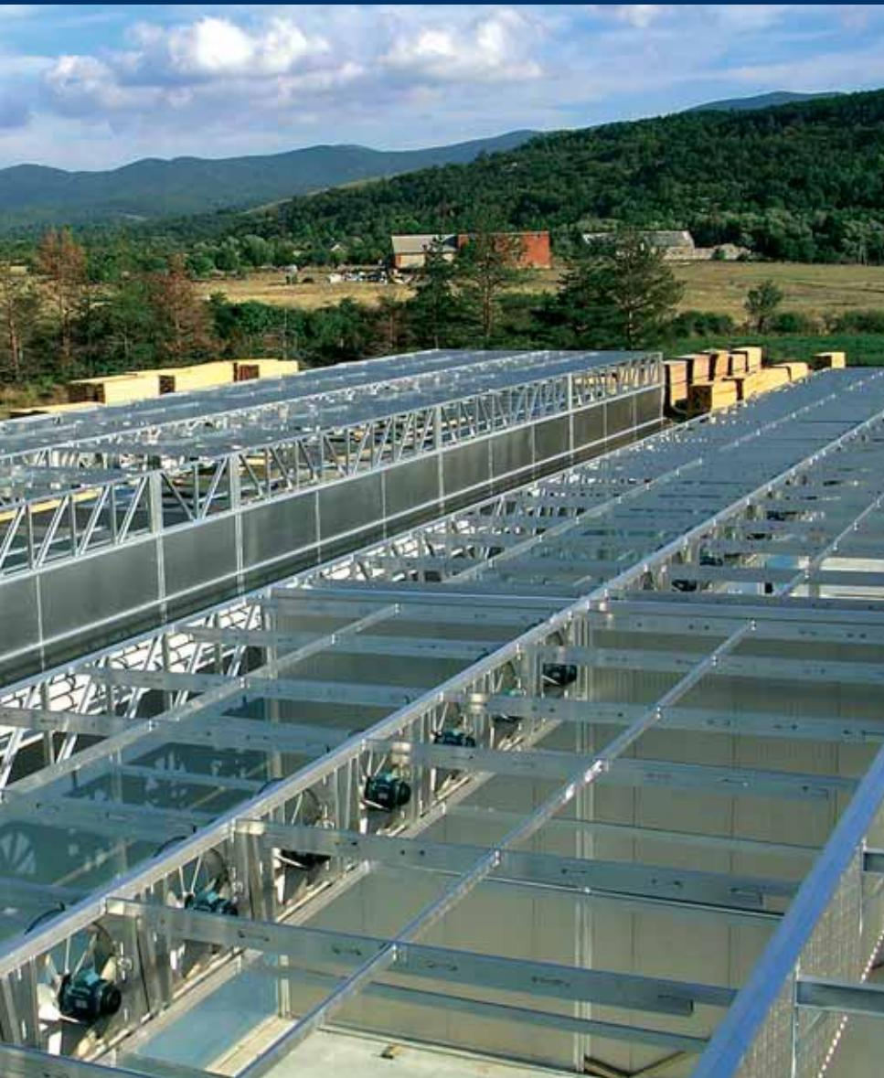
Сушильные камеры SECAL снабжены двусторонними вентиляторами из алюминиевых сплавов. Раствор выполнен из нержавеющей стали значительной толщины с двойной кромкой.
