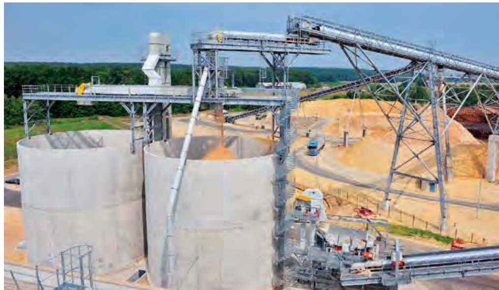
Hackschnitzelförderung und -lagerung
