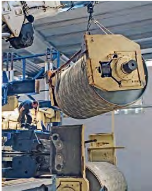
Antriebstrommeln mit Reibbelägen im Pressenauslauf
