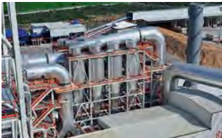
Zyklone einer 76-MW-Energieanlage
