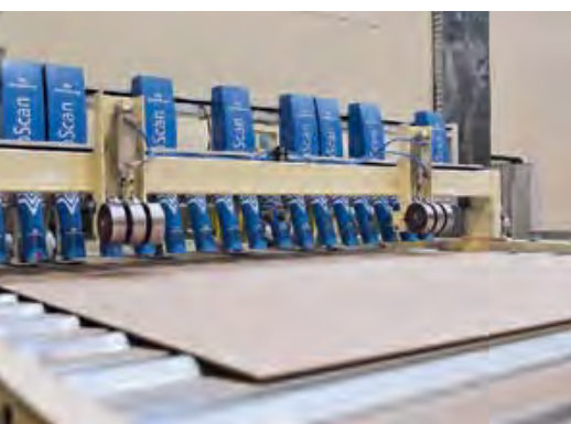
SicoScan-Ultraschallmesstechnologie zur Spaltererkennung mit Plattendickenmessung
