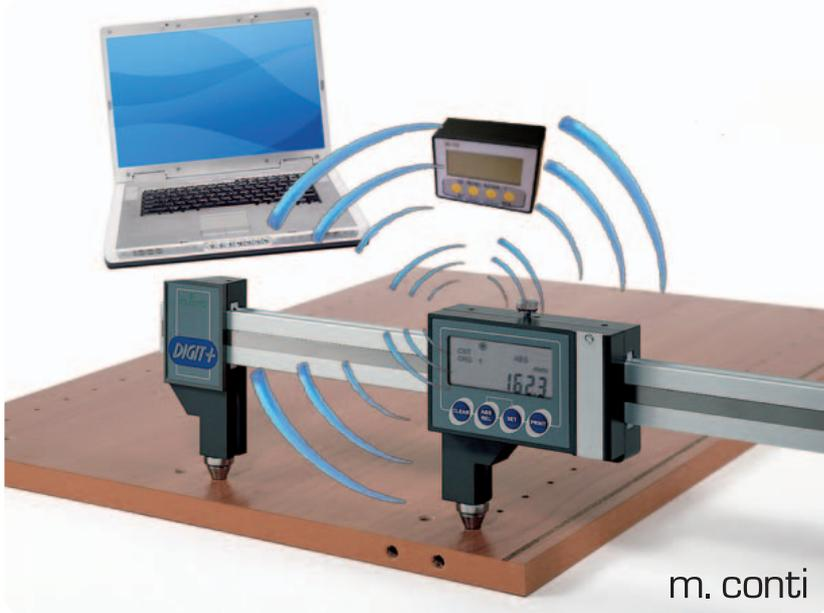
Die Schieblehre mit Funkverbindung bestehen aus einem in der Schieblehrendisplay integrierten Sender und einem „Master“ für die Empfangung von der Werten, die auf dem Display der digitalen Schieblehre erscheinen und durch Radiowellen übermittelt werden.
