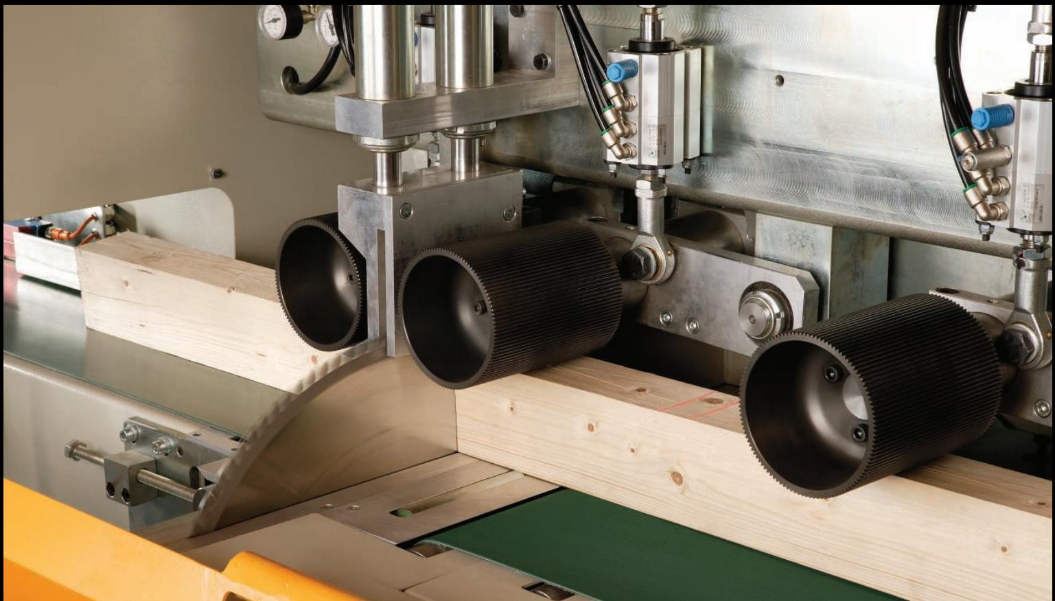
*Sistema integrale di trazione: il doppio sistema di avanzamento del pezzo in lavorazione avviene nella parte inferiore tramite un nastro di avanzamento ad alta aderenza mentre nella parte superiore tramite rulli dentati che si adattano perfettamente al legno, favorendo così il corretto avanzamento anche di tavole grezze, non piene.*
