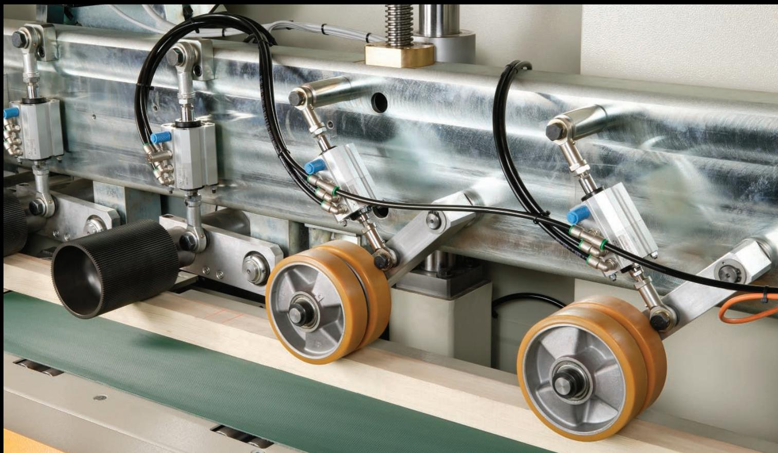
*Sistema integrale di trazione: il doppio sistema di avanzamento del pezzo in lavorazione avviene nella parte inferiore tramite un nastro di avanzamento ad alta aderenza mentre nella parte superiore tramite rulli dentati che si adattano perfettamente al legno, favorendo così il corretto avanzamento anche di tavole grezze, non piane.*
